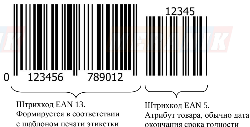
Рис. 7.2 – Структура штрихкода EAN 13+5
